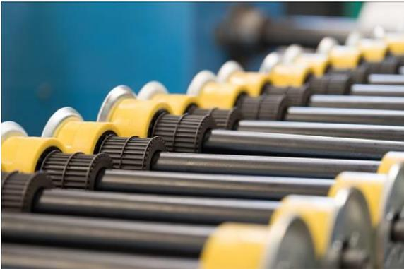
**Bild 3:** Der Maschinenbauer legt die Rollenförderer auf das geforderte Gewicht der zu transportierenden Last aus.
