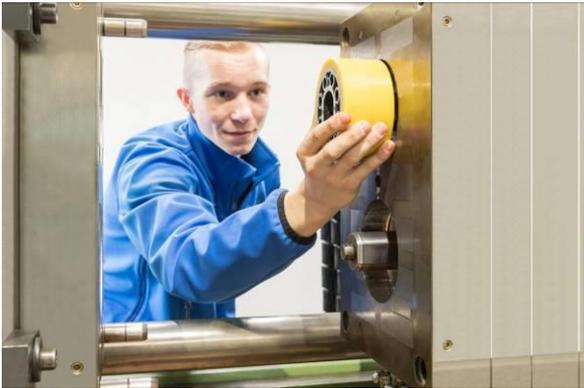
**Bild 6:** Durch die kraftschlüssige Verbindung der Toleranzhülsen kann der Service-Techniker vor Ort die Komponenten einfach tauschen.
