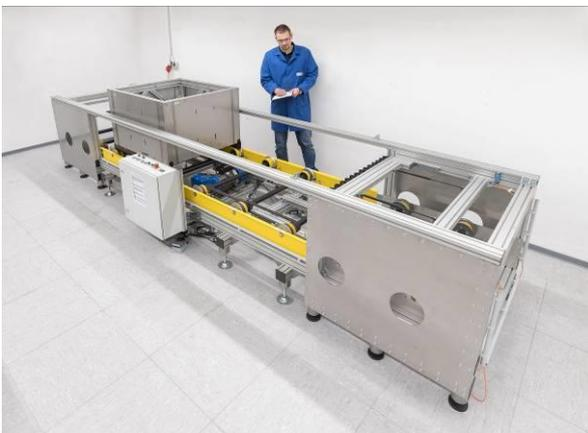
**Bild 7:** Auf dem Prüfstand simulieren die Techniker den tatsächlichen Einsatz der Tragrollen. Ein Schlitten fährt im Dauerbetrieb auf der Rollbahn. Dabei kann die Belastung auf die Rollen entsprechend den Kundenanforderungen angepasst werden.
