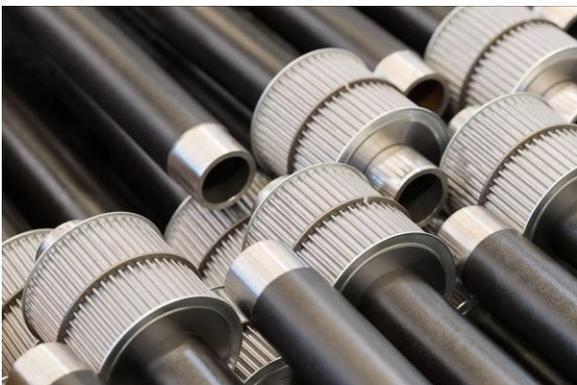
**Bild 4:** Um die Umfangskraft des Zahnriemens auf die Zahnscheibe und von dort zum Rohr zu übertragen, wird die Zahnscheibe dauerhaft mit dem Rohr verbunden.
