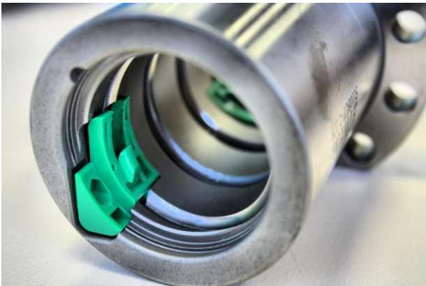
Bild 4: Im Falle des Endkappenumlenksystems werden die Kugeln beim Austritt aus der tragenden Zone von der Endkappe in die tragende Zone zurückgeleitet.
