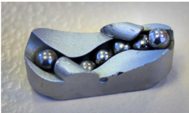
Bild 5: Umlenkstücke sind entscheidende Komponenten für Kugelrollspindeln. Sie sorgen dafür, dass Kugeln im Umlenkstücksystem zuverlässig wieder an den Anfang des Gewindeganges geleitet werden.
