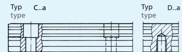
Führungswagen mit Halblech und Seitendichtung
