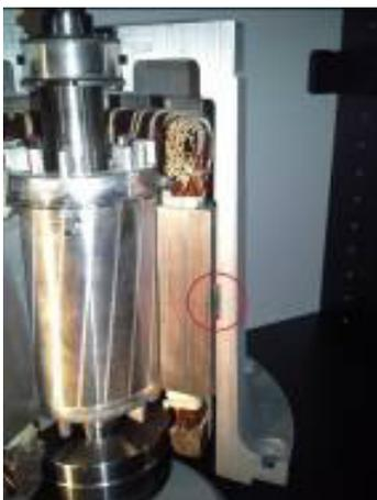
Anwendung im Elektromotor: Die Toleranzhülse zentriert einen Stator im Gehäuse und fixiert diesen zudem gegenüber den Drehmomentkräften des Rotors.
