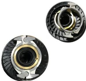
Im Falldämpfer ermöglicht die Toleranzhülse bei einem Absturz ein kontrolliertes Durchrutschen zwischen Gurtrolle und Bremse. Sie wirkt dabei wie eine Rutschkupplung als Überlastungsschutz.
